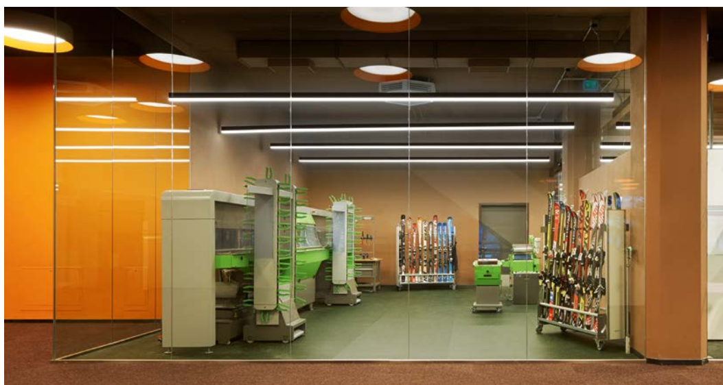
Skiservice-Werkstatt mit vollautomatischer Serviceanlage Discovery sdp (Stein, Disc, Polier), Bandschleifmaschine Sigma Eco und Heißwachsmaschine Waxjet Pro
