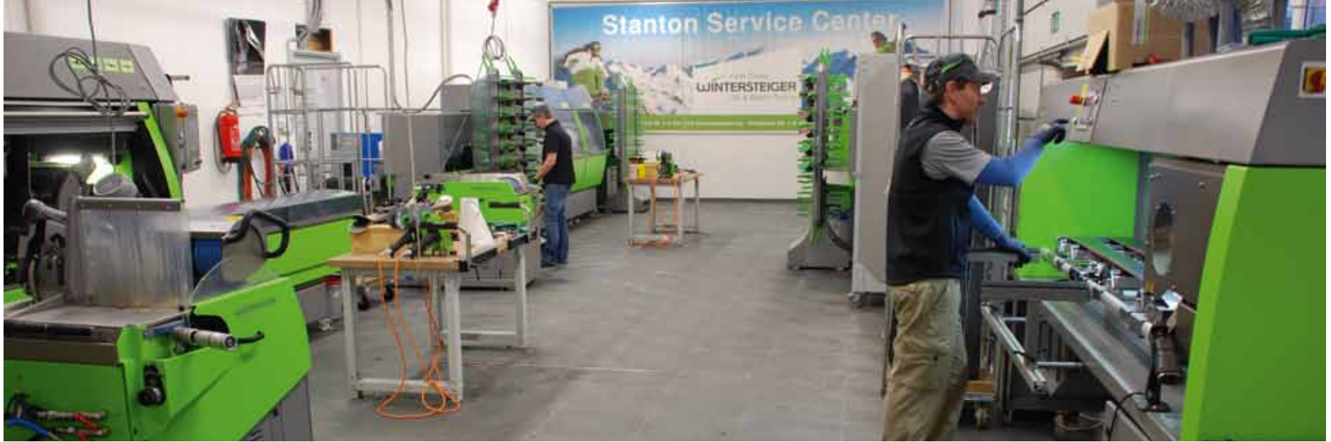
Modernster Maschinenpark. Im Stanton Service Center stehen u.a. zwei Discovery SSF und ein Tunejet Schleifautomat ein Basejet Belagreparaturautomat sowie eine Snowboard-Bandschleifmaschine.
