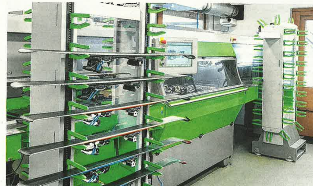
Ski werden in eine Art Magazin gelegt und von der Maschine vollautomatisch präpariert.
